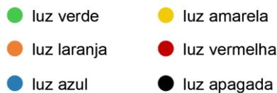
**Figura 2** – Codificação de cores para sinalizações luminosas de pátio de aeronaves
