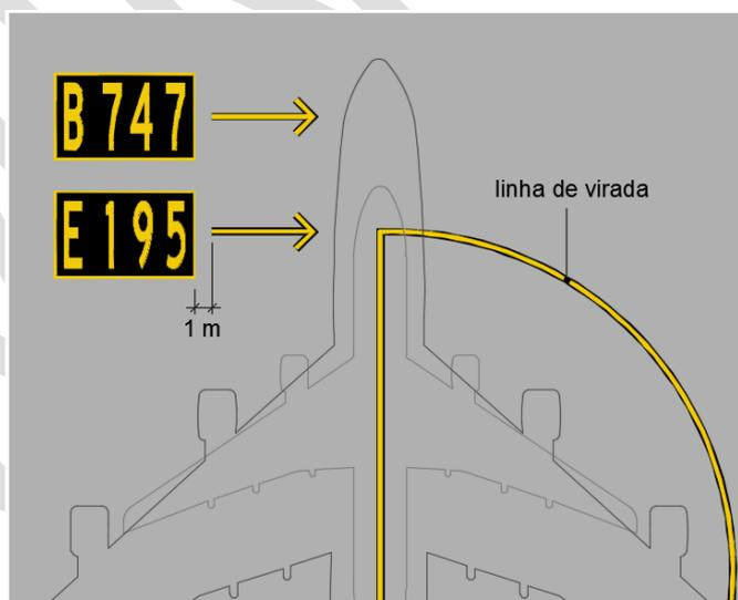
**Figura 11** – Codificação de barras de virada
