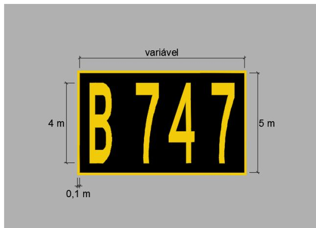
**Figura 32** – Sinalização horizontal de identificação de barra de virada e de linha de parada.
