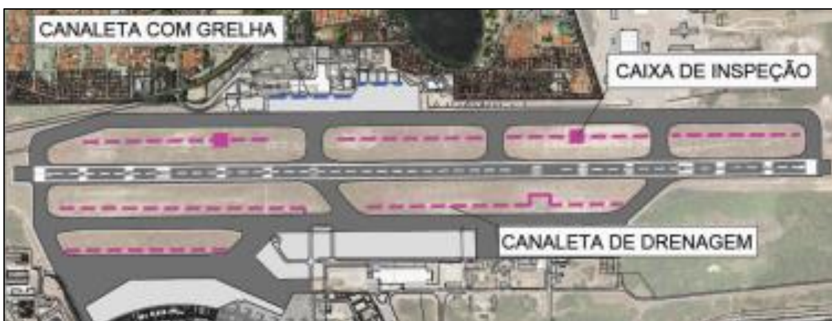
Figura 38: Desenho esquemático da rede de drenagem
