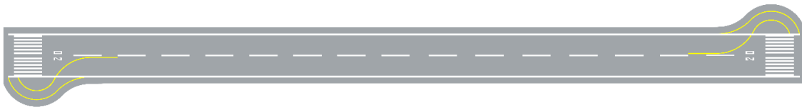
Figura C-1B. Disposição típica de uma área de giro de pista de pouso e decolagem. (Alterado pela Resolução nº 465, de 13.03.2018)
