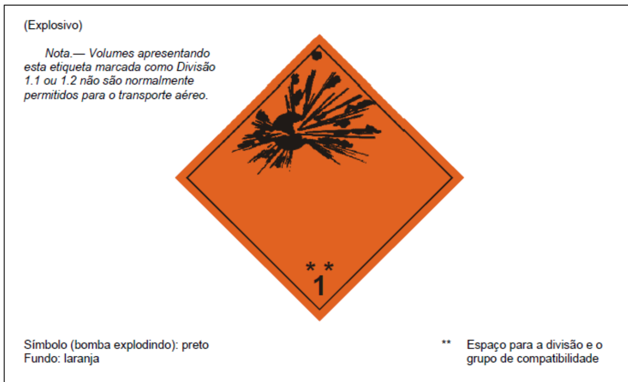
Figura E-5: Explosivo, Classe 1, Divisões 1.1, 1.2 e 1.3
