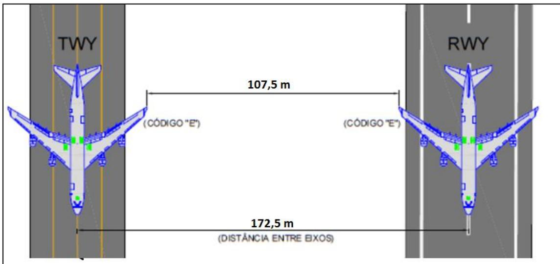
**Figura 15** - Separação entre pontas de asa (fonte: Infraero)
