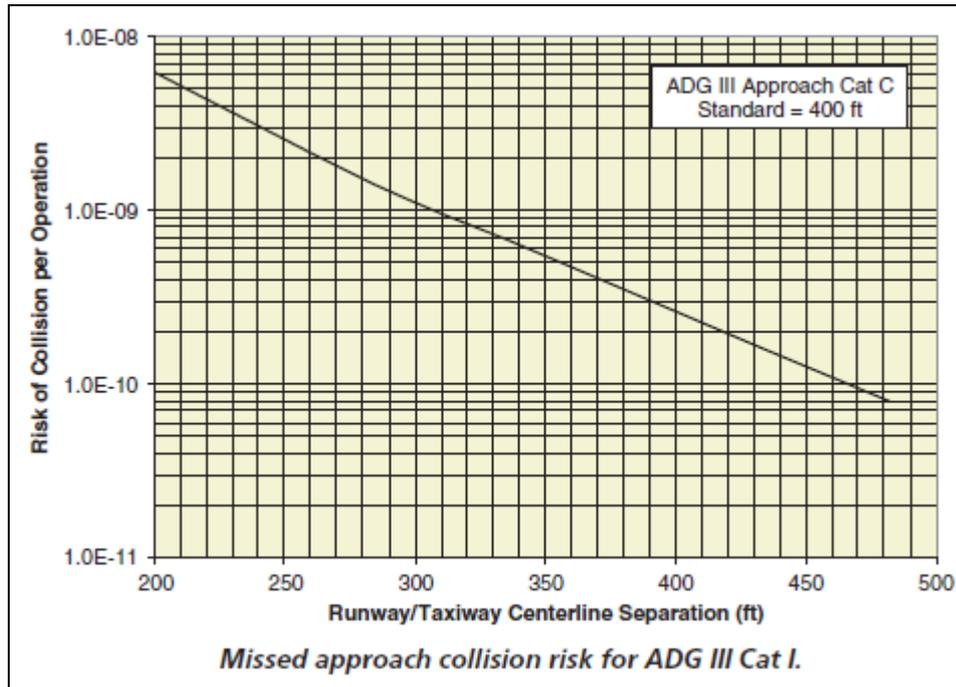
**Figura 6** – Exemplo de ábaco apresentado no ACRP 51: Risco de colisão, para uma aproximação perdida, operação CAT I e ADG-III e AAC-C (segundo os critérios de classificação da FAA)<sup>2</sup>
