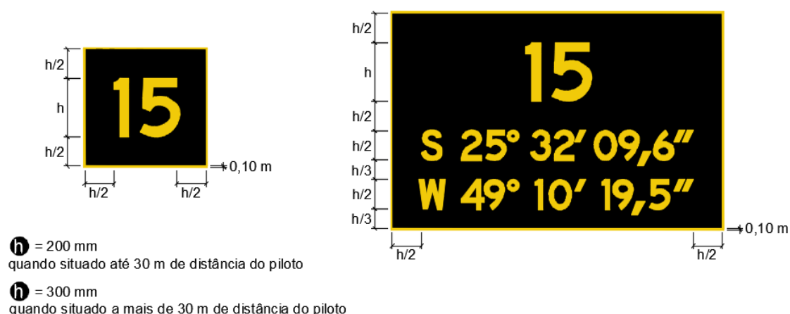
Figura 41 – Sinalização vertical de designação de posição de estacionamento com e sem coordenadas
