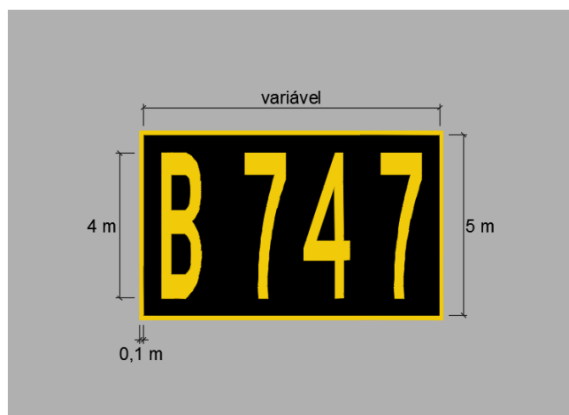
Figura 33 – Sinalização horizontal de identificação de barra de virada e de linha de parada.
