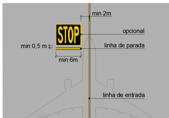
Figura 14 – Linha de parada com sinalização horizontal de “STOP”
