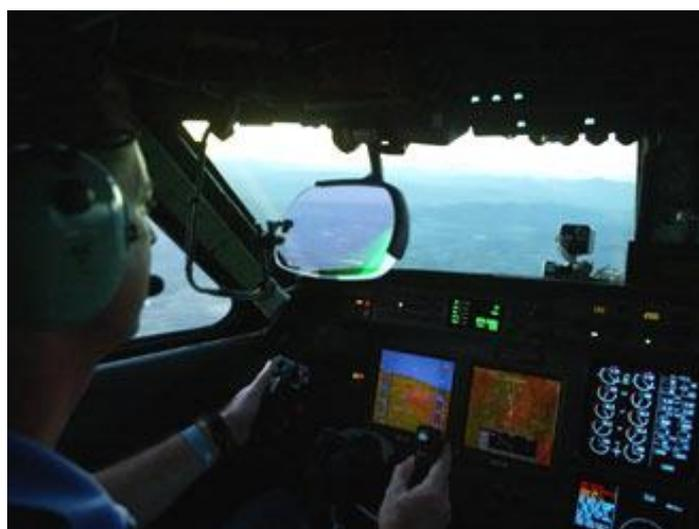
Figura 2- A cabine do Gulfstream GV da NASA com uma tela de sistema de visão sintética. O HUD está na frente do piloto (com um projetor montado acima dele) (fonte: *NASA Public Domain*)
