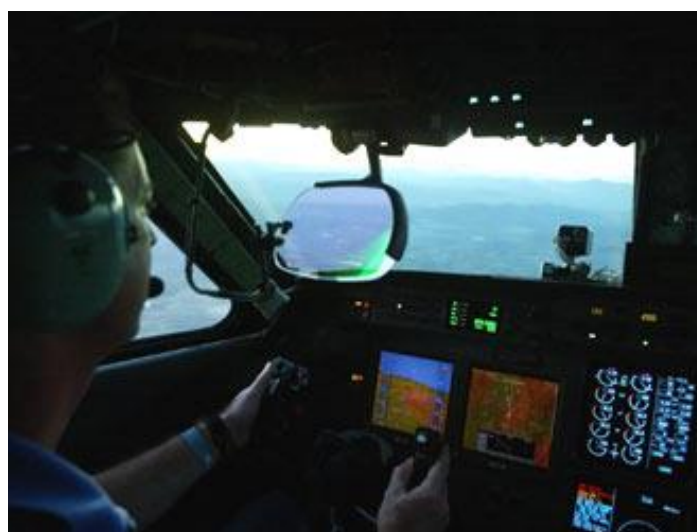
Figura 2- A cabine do Gulfstream GV da NASA com uma tela de sistema de visão sintética. O HUD está na frente do piloto (com um projetor montado acima dele) (fonte: NASA Public Domain )
