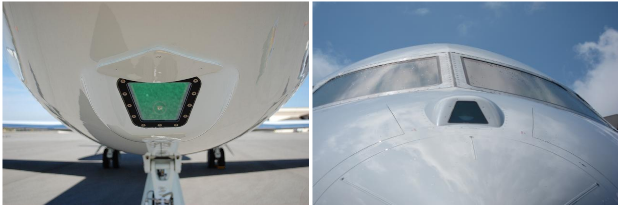
Figura 5 - Sensor de um sistema EVS instalado em um Gulfstream [fonte: Spartam7W (2012)] (à esquerda) e em um Global 6000 [fonte: Oliver Cleynen (2013)] (à direita).
