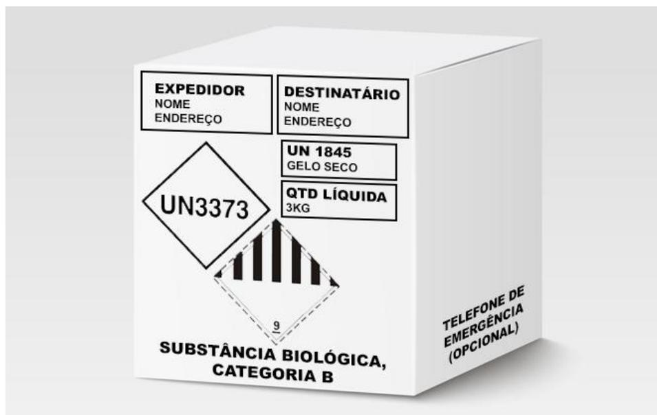
**Figura 10:** Marcação e etiquetagem de volume contendo *UN 3373* e gelo seco
