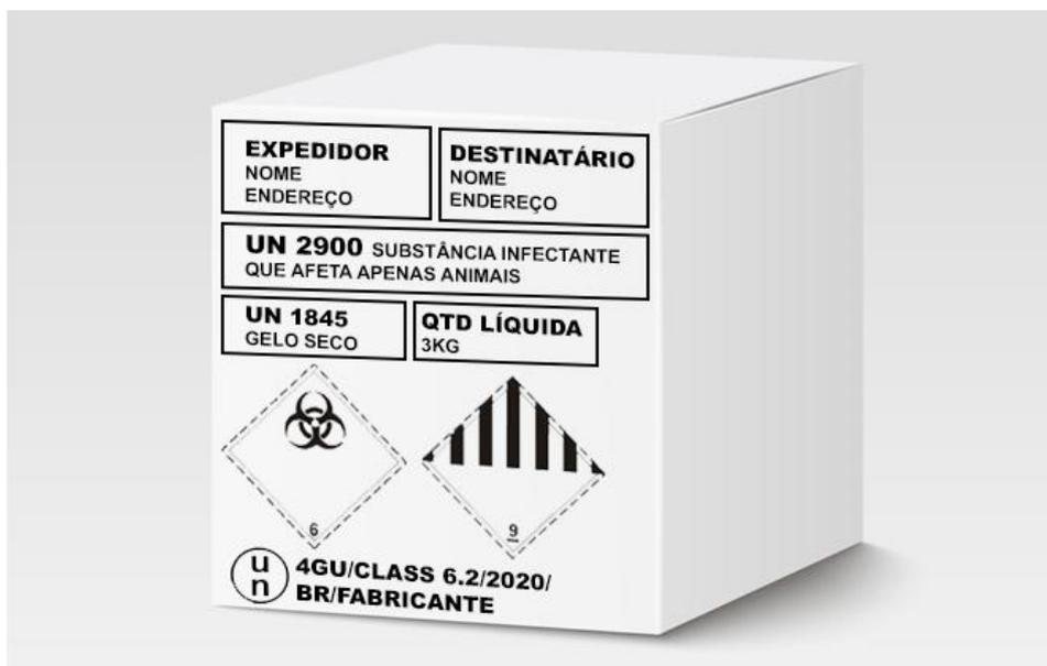
**Figura 9:** Marcação e etiquetagem de volume contendo *UN 2900* e gelo seco
