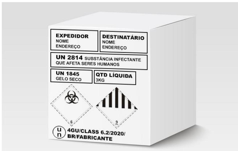
**Figura 8:** Marcação e etiquetagem de volume contendo UN 2814 e gelo seco
