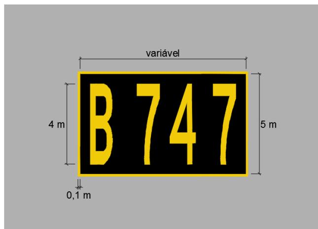
**Figura 33** – Sinalização horizontal de identificação de barra de virada e de linha de parada.
