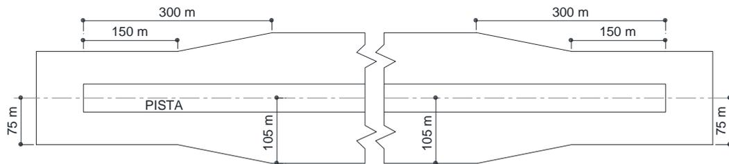
Figura C-2. Parte nivelada de uma faixa de pista, incluindo uma pista de aproximação de precisão onde o número de código é 3 ou 4. (Alterado pela Resolução nº 465, de 13.03.2018)
