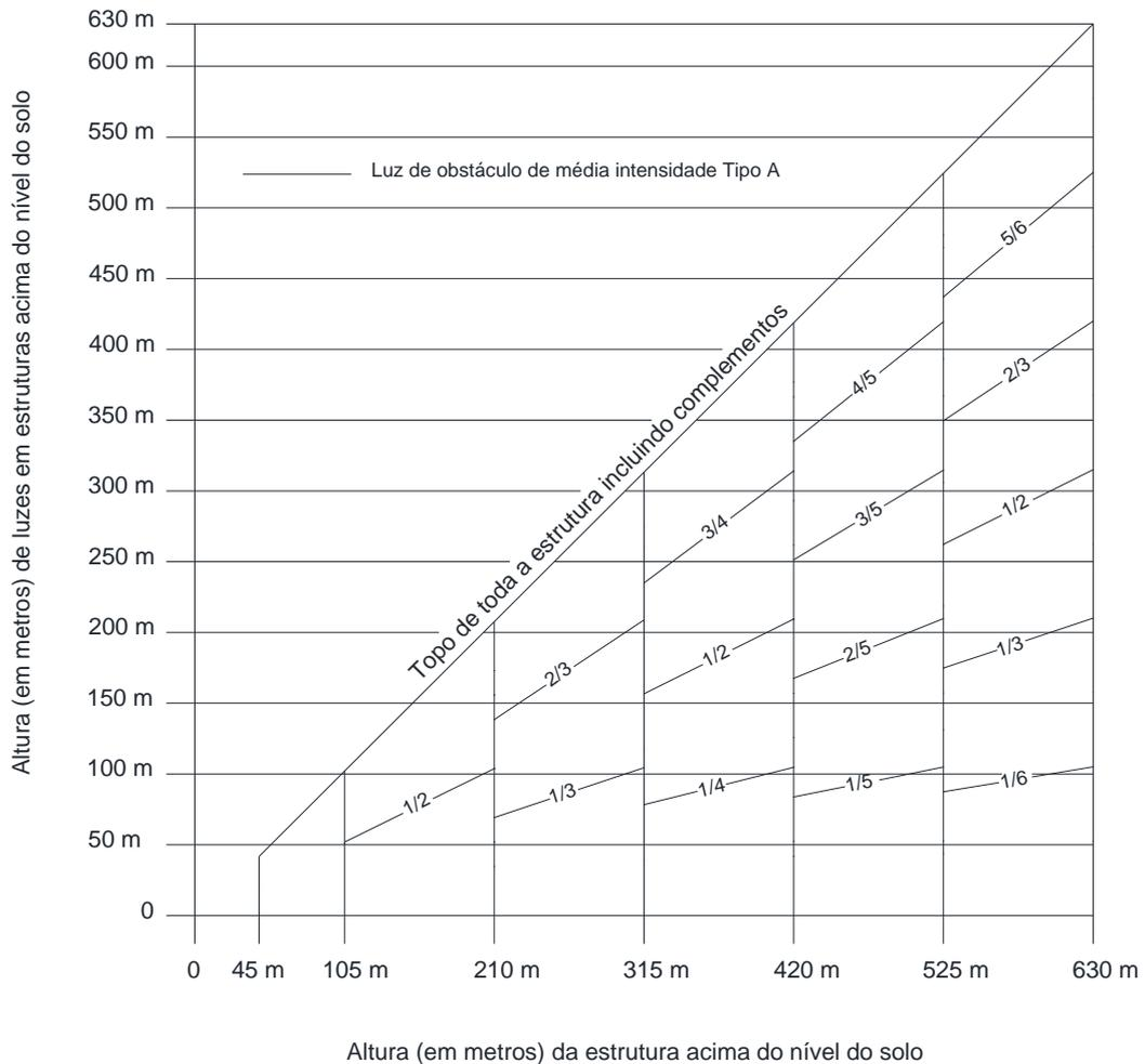
Figura AF-1. Sistema de iluminação de obstáculos de média intensidade com luzes brancas intermitentes, Tipo A (Alterado pela Resolução nº 465, de 13.03.2018)
