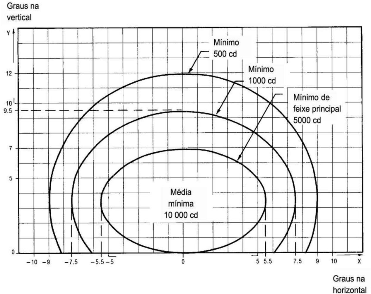
Figura AB-9. Diagrama de isocandela para as luzes de borda da pista de pouso e decolagem quando a largura da pista for de 45m (luz branca)
