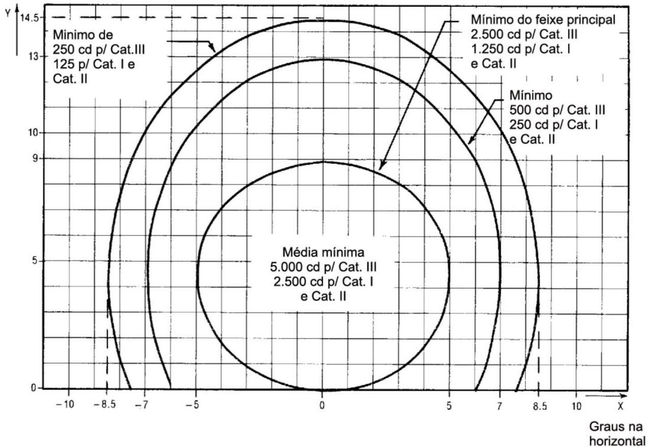
Figura AB-7. Diagrama de isocandela para as luzes do eixo da pista de pouso e decolagem com espaçamento longitudinal de 15 m (luz branca) e luz indicadora de pista de táxi de saída rápida (luz amarela)
