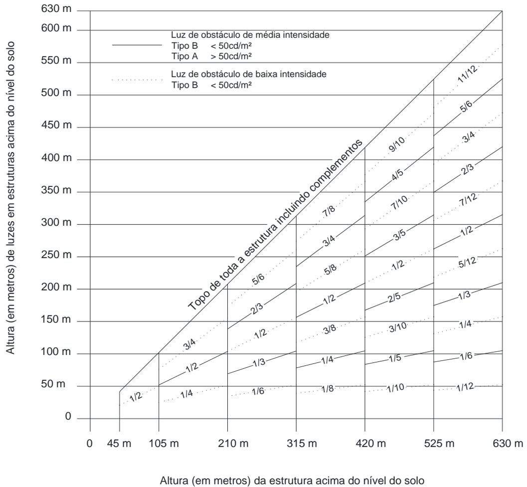
Figura AF-4. Sistema duplo de iluminação de obstáculos de média intensidade, Tipo A / Tipo B
