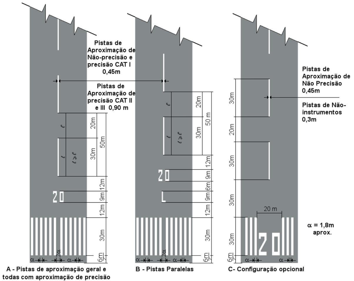
Figura D-2. Sinalização horizontal de designação de pista de pouso e decolagem, de eixo e cabeceira (Alterado pela Resolução nº 465, de 13.03.2018)
