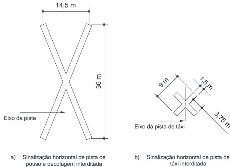
Figura E-1. Sinalizações horizontais de pistas de pouso e decolagem e de pista de táxi interditas
