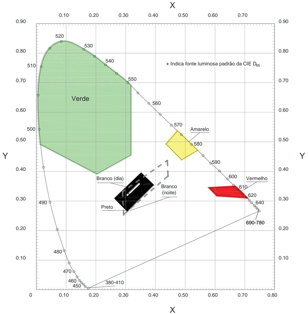
Figura AA-4. Cores de sinalizações verticais e painéis luminosos (iluminados internamente) ou luminescentes
