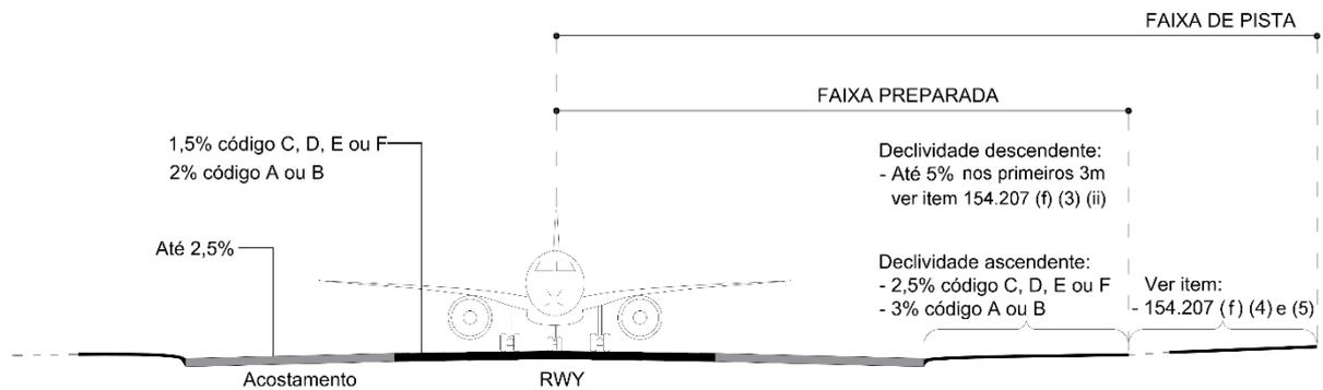
Figura C-1A. Declividades transversais da pista para favorecimento da drenagem de água (Incluído pela Resolução nº 465, de 13.03.2018)
