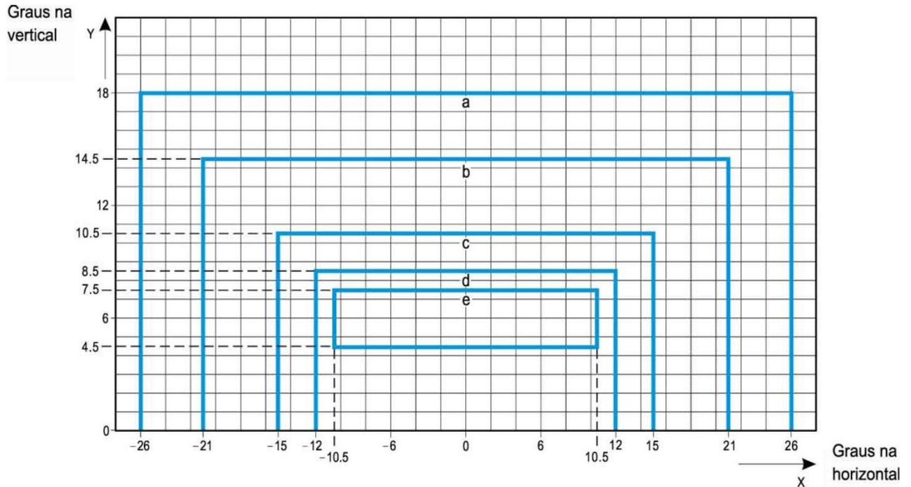
Figura AB-17. Diagrama de isocandela para as luzes de eixo de táxi de alta intensidade (espaçamento de 15 m) e de barras de parada em seções retas destinadas ao uso em um sistema avançado de controle e orientação de movimentos em superfície onde são exigidas intensidades de luz mais altas e onde podem ocorrer grandes correções.
