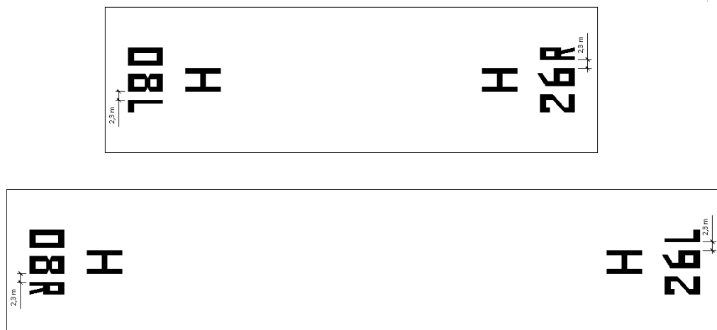
Figura 155.317-2 – Duas FATO tipo pista de pouso e decolagem paralelas.
