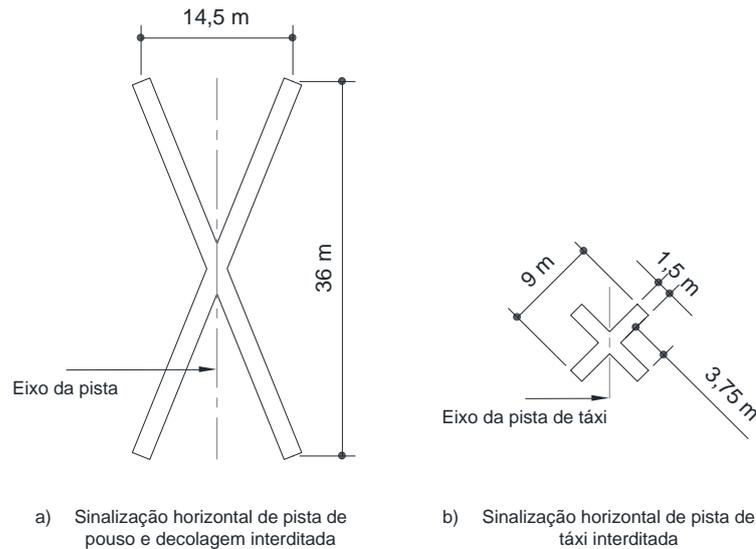
Figura E-1. Sinalizações horizontais de pistas de pouso e decolagem e de pista de táxi interdidadas
