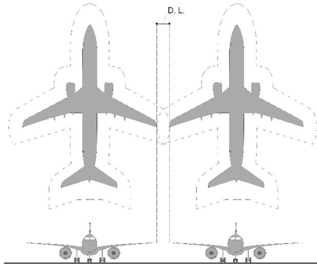
Figura C-5. Representação de afastamentos mínimos entre aeronaves (Incluído pela Resolução nº 465, de 13.03.2018)
