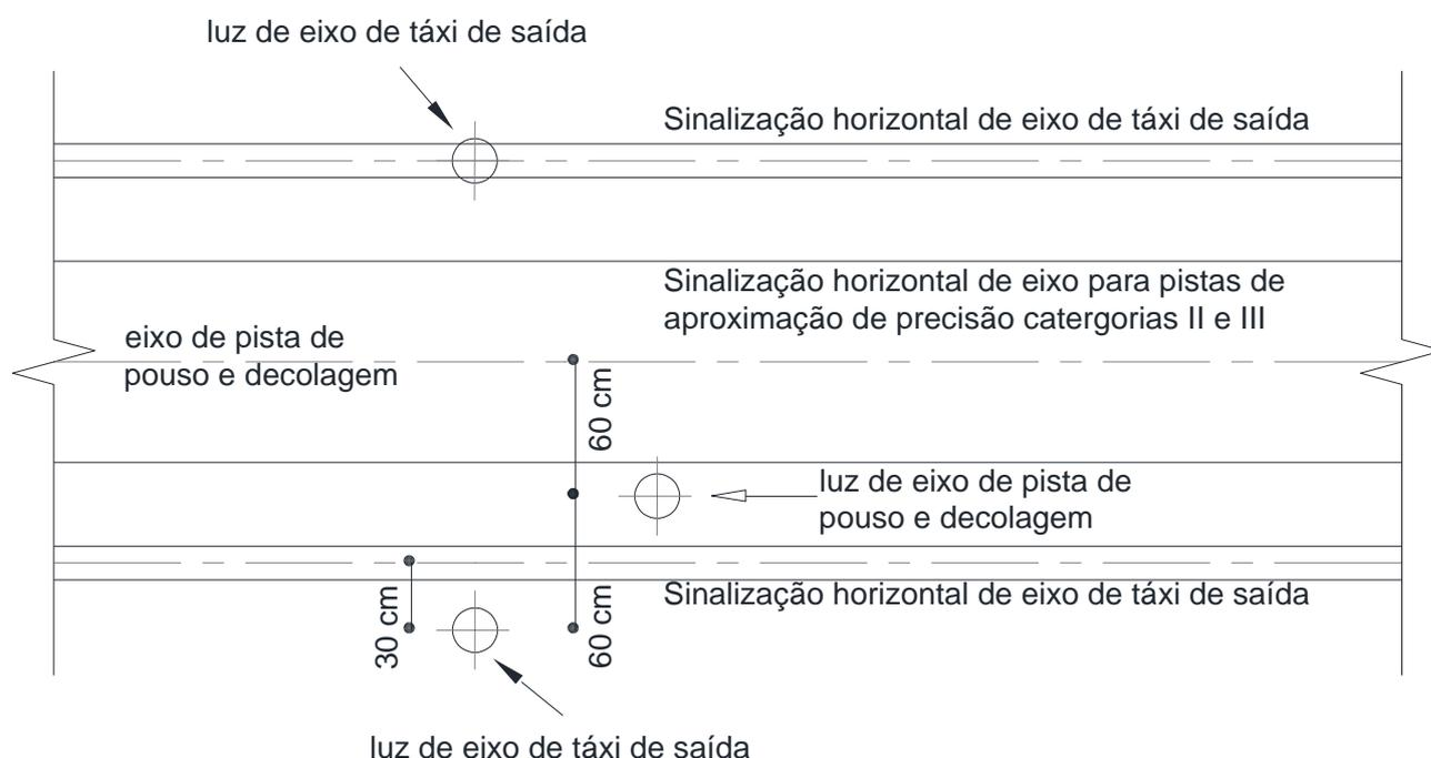
Tolerâncias de desalinhamento das luzes de eixo de pista de pouso e decolagem e de luzes de eixo de pista de táxi devem manter 60 cm de separação
