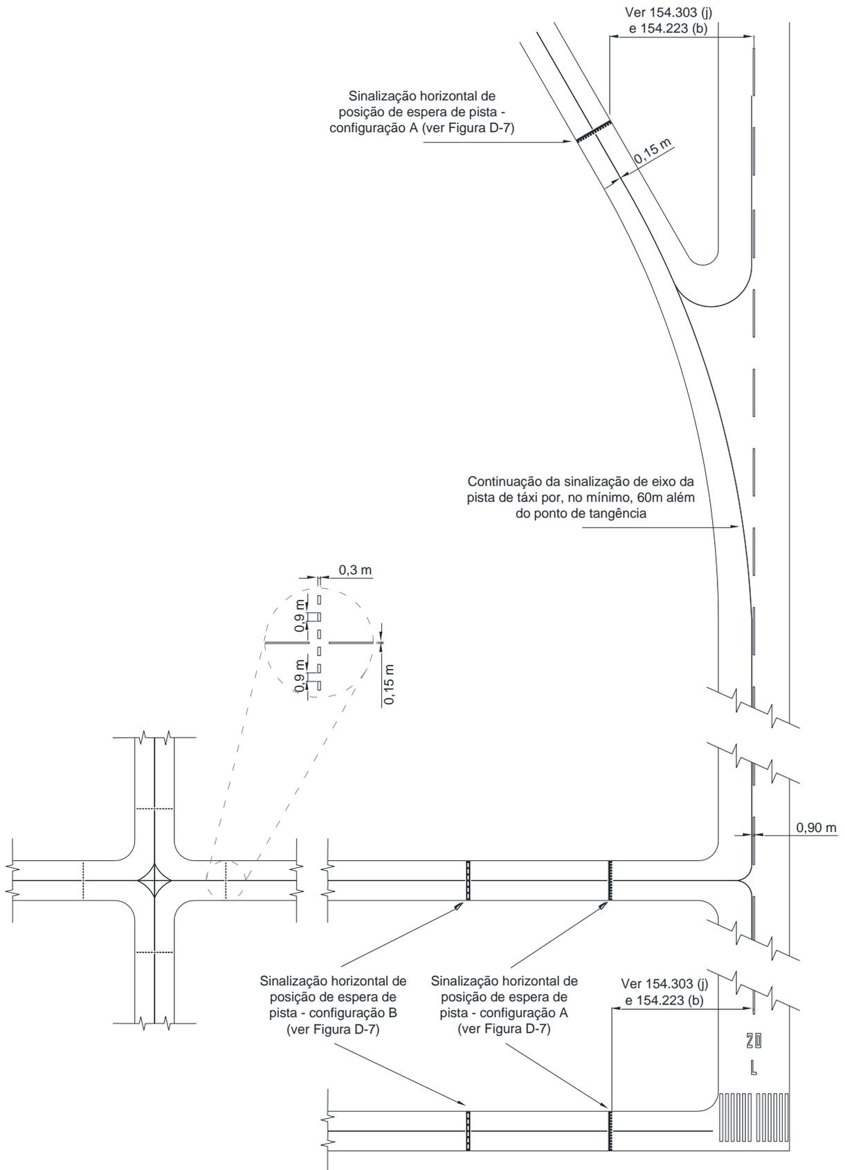
Figura D-6. Sinalização horizontal de pista de táxi (exibida em conjunto com a sinalização horizontal básica de pista de pouso e decolagem) (Alterado pela Resolução nº 465, de 13.03.2018)
