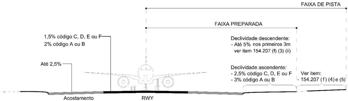
Figura C-1A. Declividades transversais da pista para favorecimento da drenagem de água (Incluído pela Resolução nº 465, de 13.03.2018)
